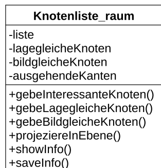
Abbildung 4.13: UML-Diagramm der Klasse Knotenliste_raum .
